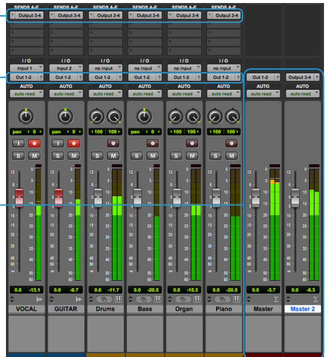
在Pro Tools的混音面板中为两个耳机单独设置输出的例子
